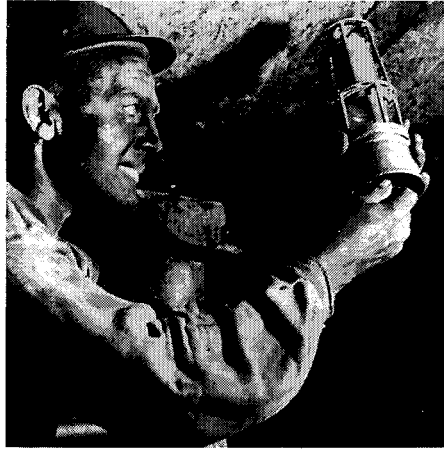
Afb. 63. aflichten met behulp van een veiligheidslamp
